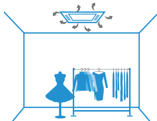
Distribuția aerului cu un filtru murdar
