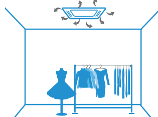
Distribuția aerului cu un filtru murdar
