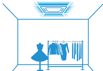
Distribuția aerului cu un filtru curat
