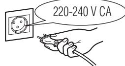
El uso de una toma de corriente que no sea de 220-240 V CA puede causar **una descarga eléctrica, un cortocircuito o un incendio.**
